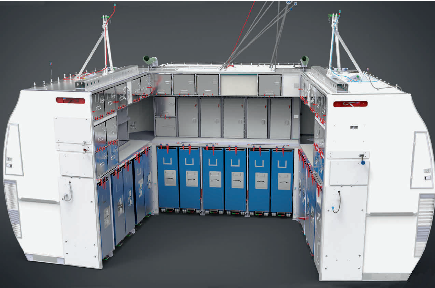
Flugzeugküchen müssen nicht nur extrem platzeffizient sein, sondern sich auch der Krümmung des Flugzeugrumpfs anpassen.
